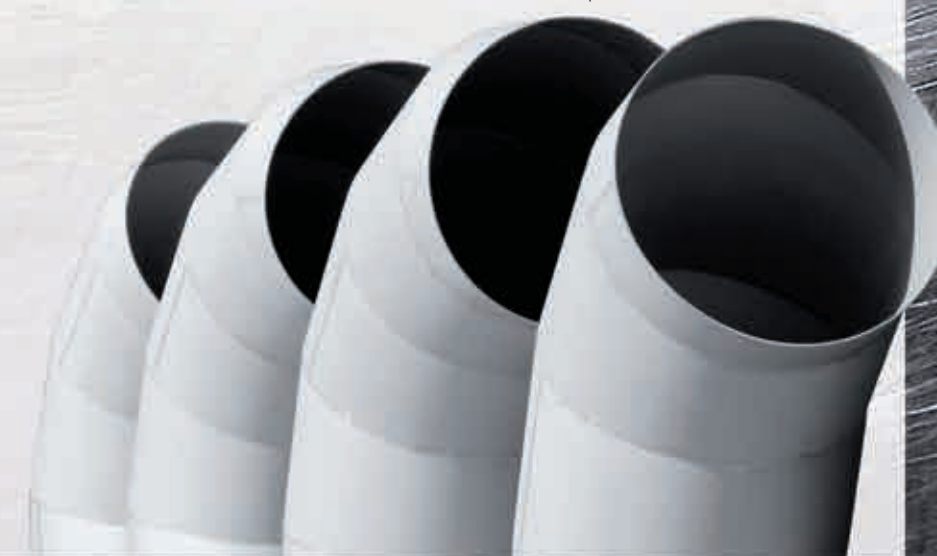
Coudes soudés en secteurs 45° ø 810-Épaisseur 4-Nuance 1.4301/AISI 304
